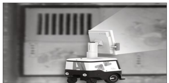
Robot của Xinhua Zhiyun có thể tự động nhận dạng mục tiêu, quay video ngắn, tải video lên đám mây theo thời gian thực và sản xuất nội dung vlog. (nguồn: Cổng Thông tin điện tử Bộ Khoa học và công nghệ)
